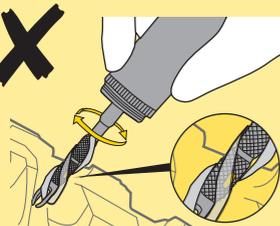
Al reparar un pinchazo, evite girar la herramienta para mantener despejado el orificio de inflado. Si el orificio de inflado está bloqueado por la mecha de reparación, es posible que se escape gas CO2 durante el inflado.
